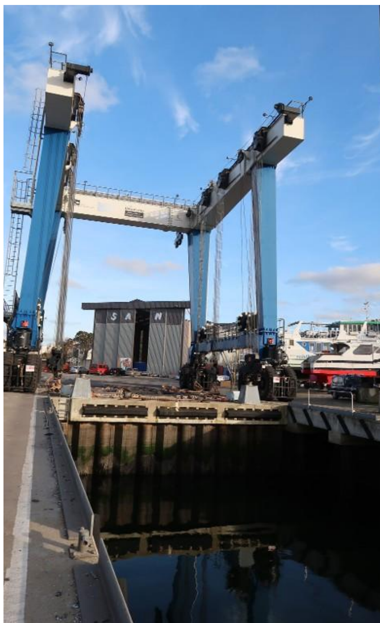
Aire de réparation navale : élévateur à bateaux
