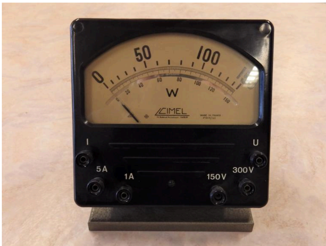
Wattmètre – Electricité dynamique (Cimel, 1950-1975)
