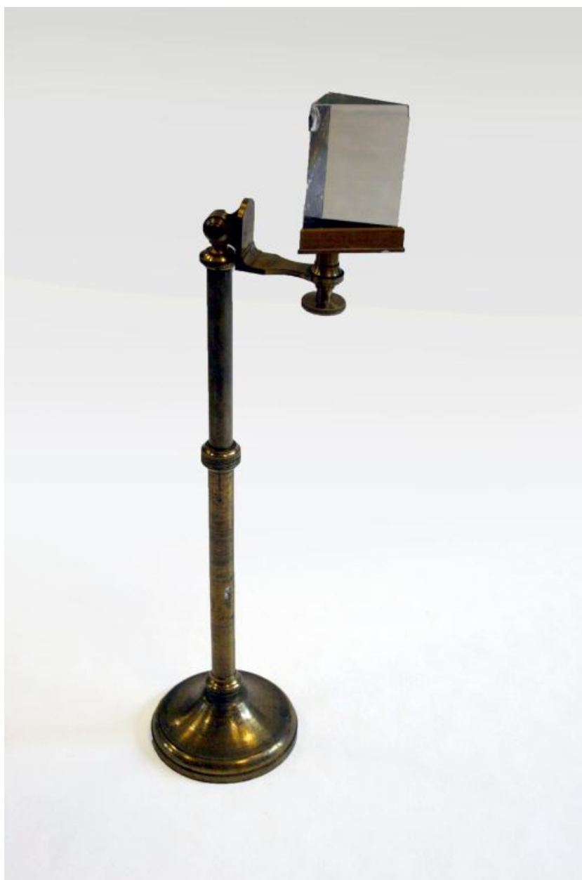
Prisme de Newton - Optique-Géodésie (J. Duboscq, 1880-1883)
