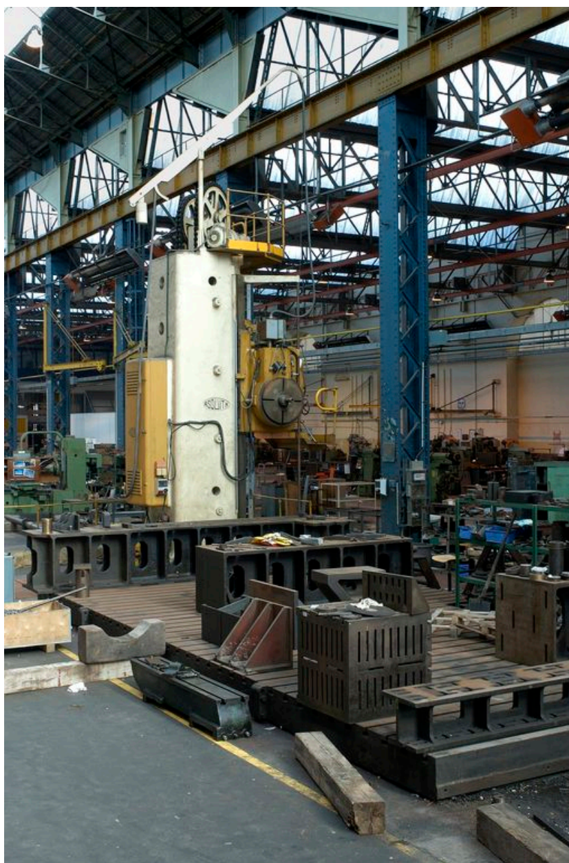
Vue de la halle d'usinage : aléseuse Malf Asquith et son marbre (1950)
