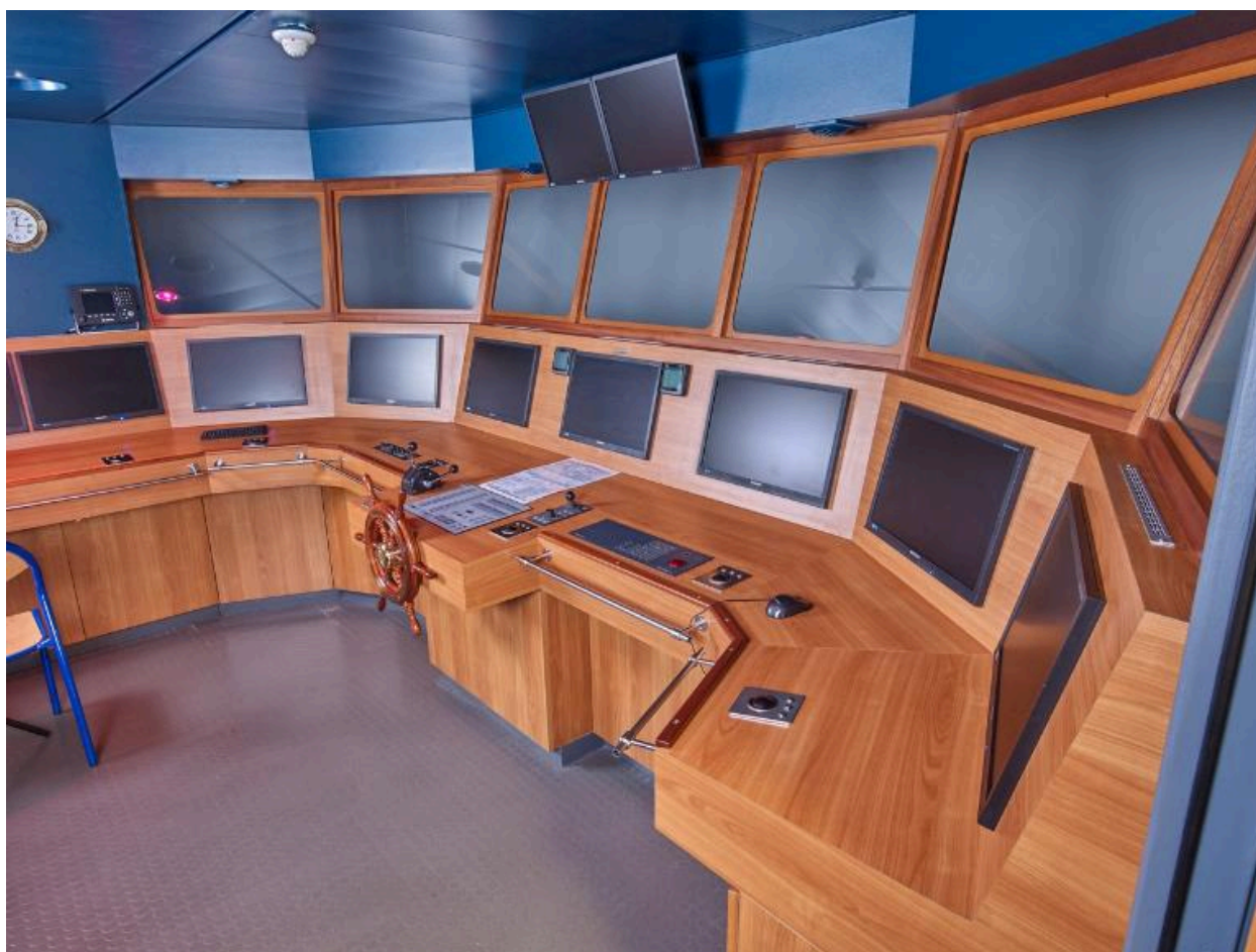
Simulateur de navigation : passerelle complète.
