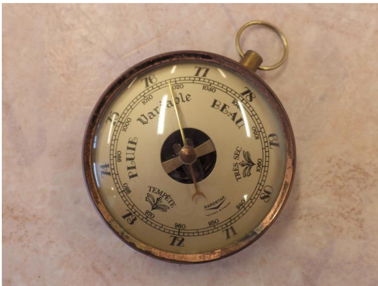
Baromètre métallique, dit holostérique - Propriétés des gaz (Barostar)
