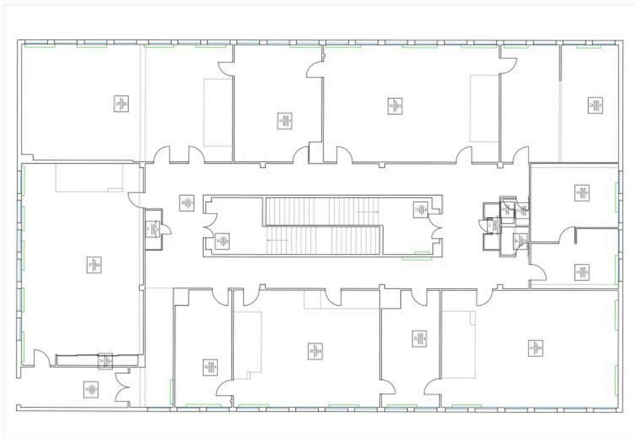
Plan du bâtiment B, 3e étage (enseignement des sciences). A noter la cage d'escalier centrale et la desserte des couloirs par deux volées superposées et indépendantes.
