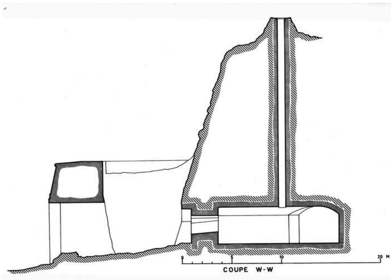
Coupe transversale W-W de la batterie de rupture sous roc de Cornouaille
