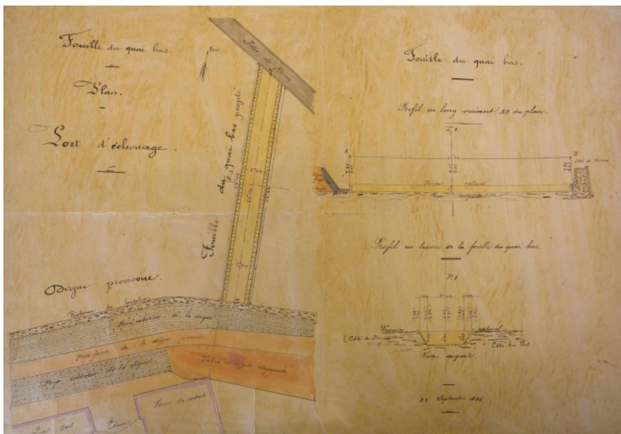
Plan : profil en long et en travers du quai Bas avec les fouilles, 1884 (AD 22)
