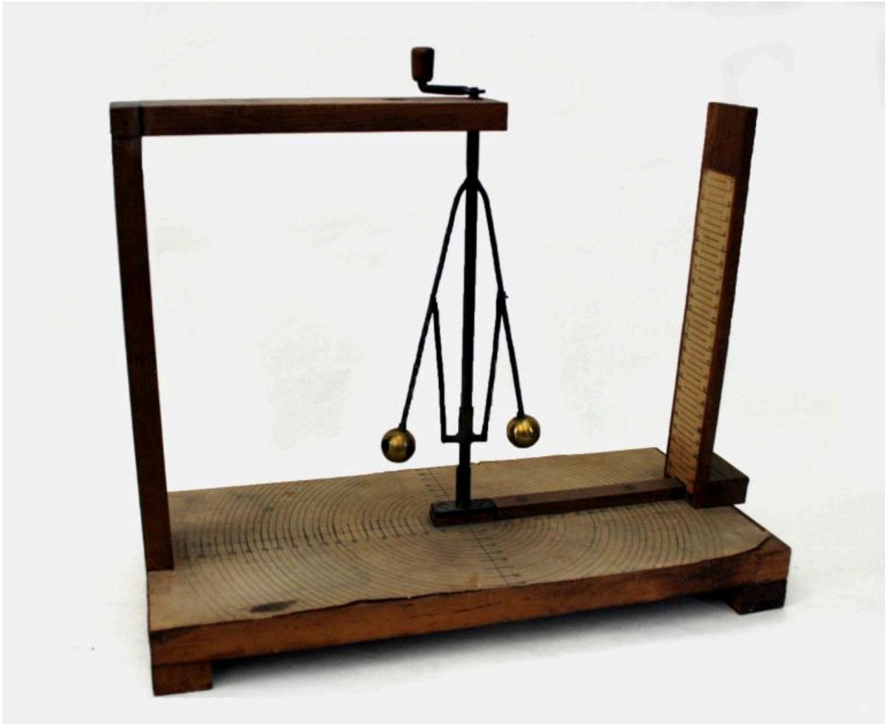
Modèle de régulateur de Watt à force centrifuge - Pesanteur-Mécanique-Mesure (Non signé)
