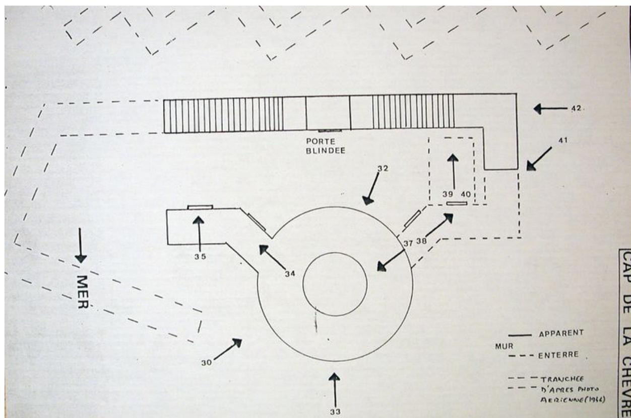
Plan du poste de direction de tir de la batterie du Cap de la Chèvre, vers 1946 (plan extrait des annexes du rapport Pinczon du Sel conservé à Brest)
