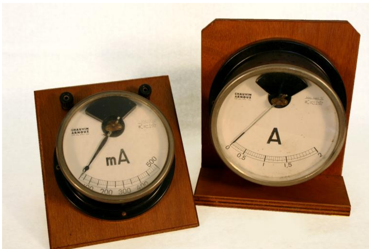
Ampèremètres- Electricité dynamique (Chauvin & Arnoux)
