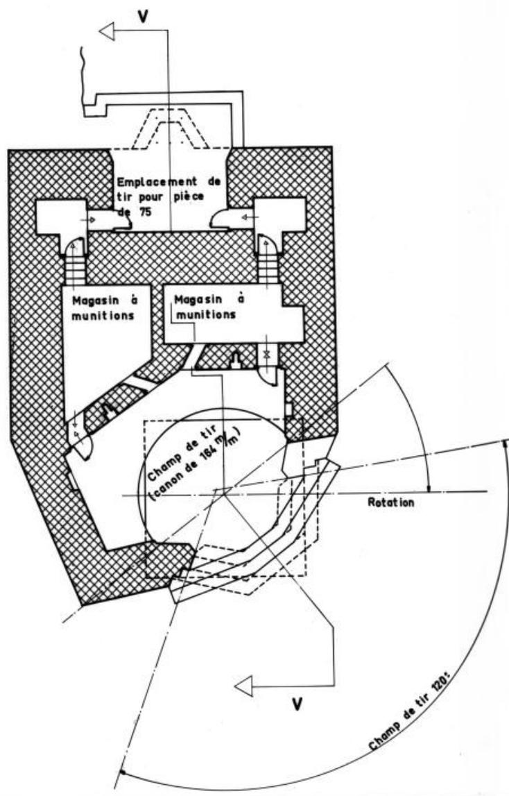
Plan de l'un des quatre bunkers - casemates pour canon de 164 mm flanquée à l'arrière d'une pièce de 75 mm
