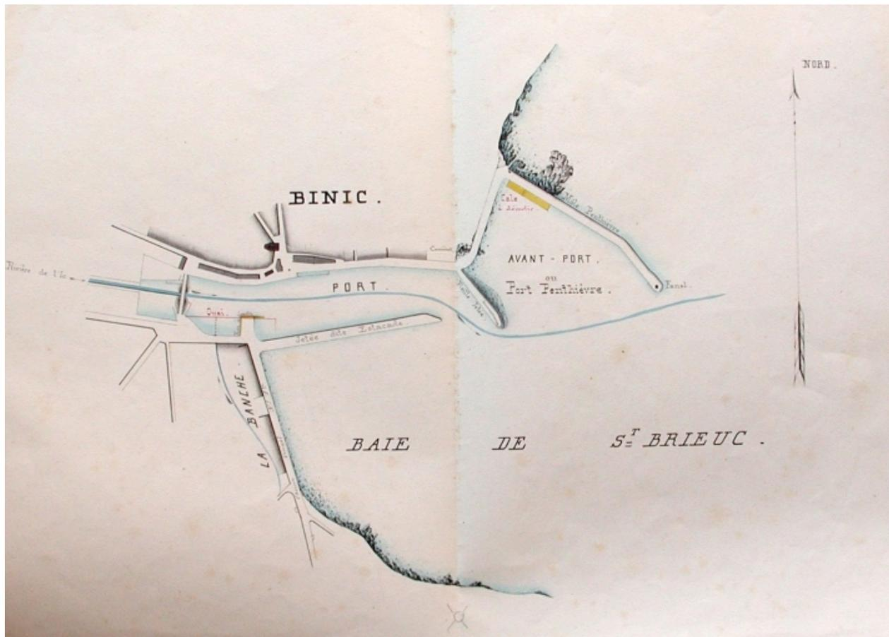
Plan : projet de construction d'un quai au fond du port, dans la partie amont, entre la levée du pont et la cale de construction, diminuée de sa largeur, 1876-77 (AD 22)
