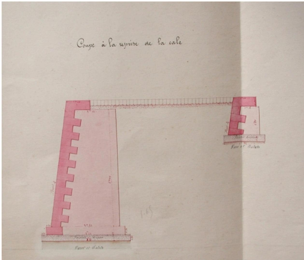
Coupe à la reprise de la cale (raccordement de la cale Hourdin au quai en amont, 1866
