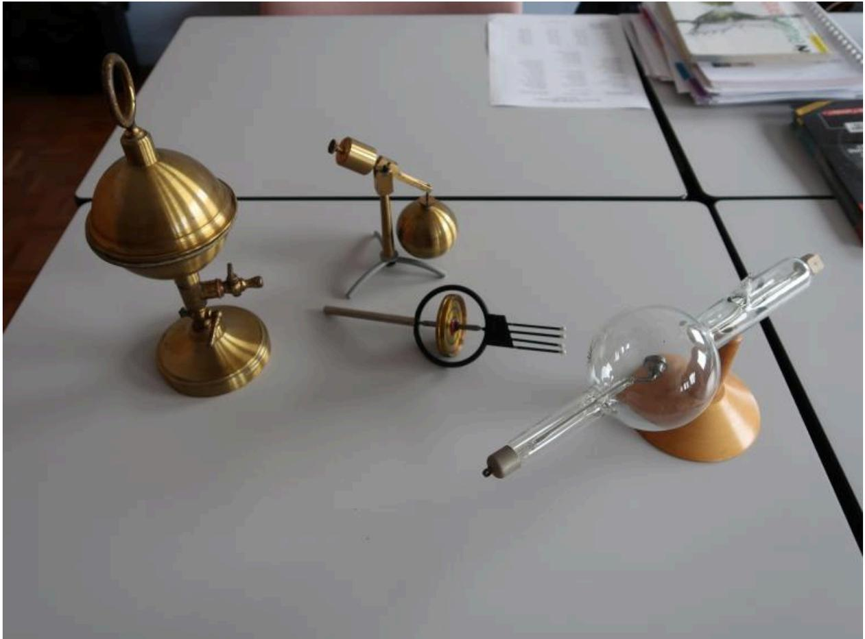
Éléments de la collection d'instruments scientifiques : gyroscope à lames, hémisphères de Magdebourg, baroscope et tube bianodique à rayons X
