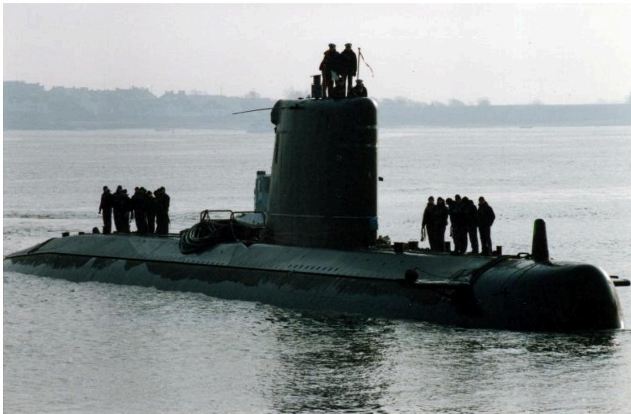
Le sous-marin Agosta arrive à la base de sous-marin de Keroman à Lorient, photographie non datée. Des câbles sont lovés à l'arrière du kiosque : antenne d'écoute passive remorquée
