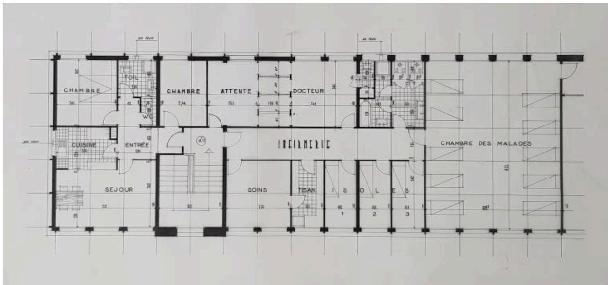
Plan de l'infirmerie (Yves Guillou architecte), avec logement T3, salle d'attente, cabinet du docteur, salle de soins, chambres d'isolés (une trame) et chambre collective pour les malades (10 lits, 4 trames), bloc sanitaire et tisanerie.
