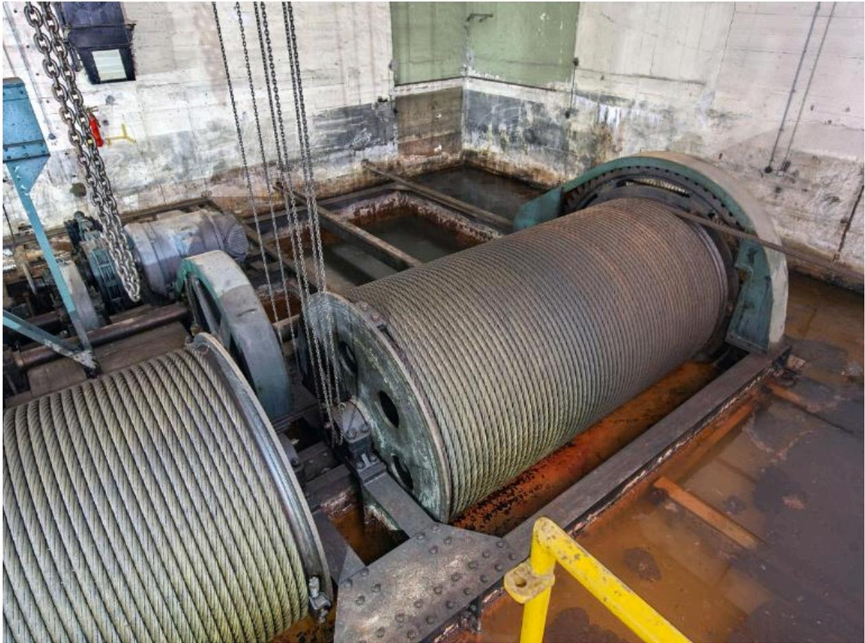
Vue des deux tambours du treuil sur lesquels sont enroulés les câbles. Les tambours mesurent 2 m de diamètre
