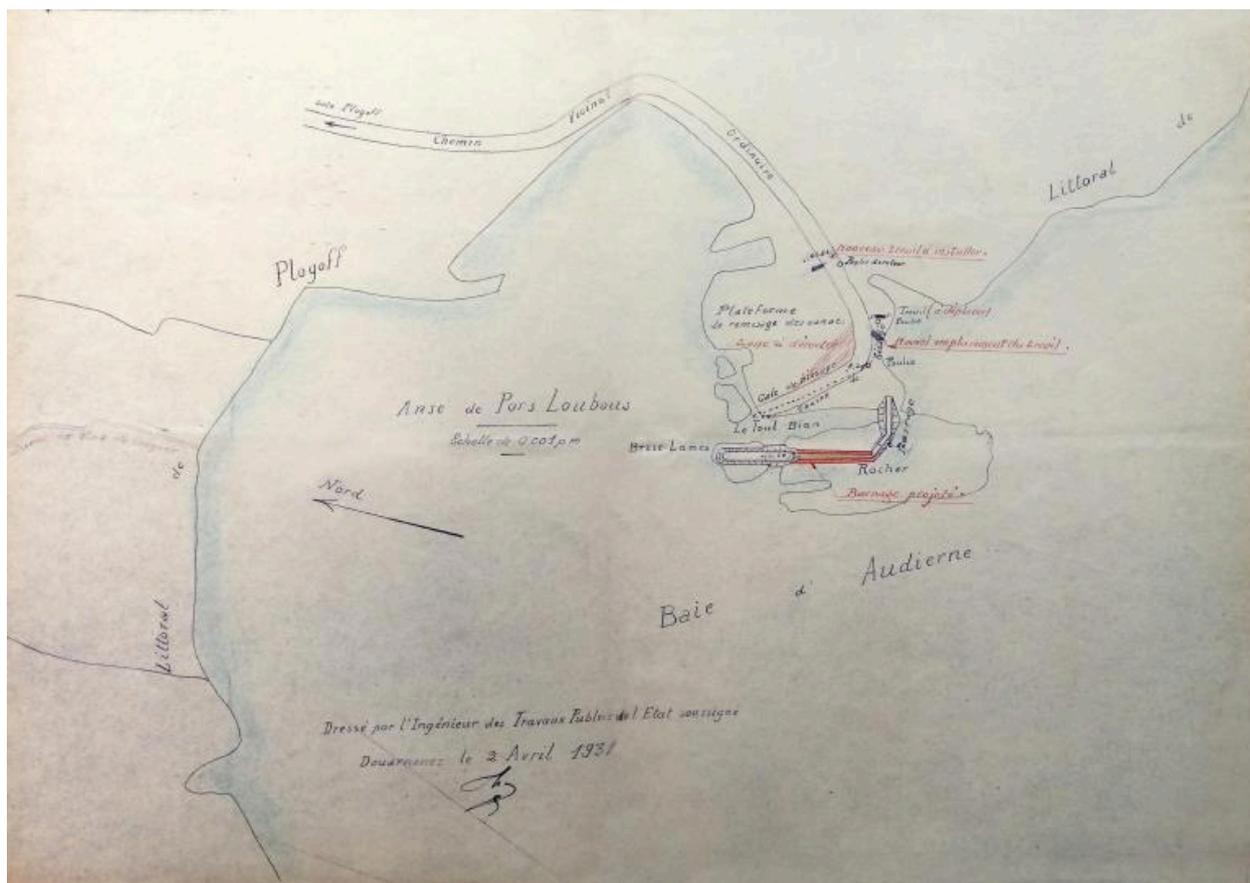
Création d'un barrage reliant le brise lame à la jetée, plans général du port. Reproduction plan des Ponts et Chaussées, 12/05/1931.
