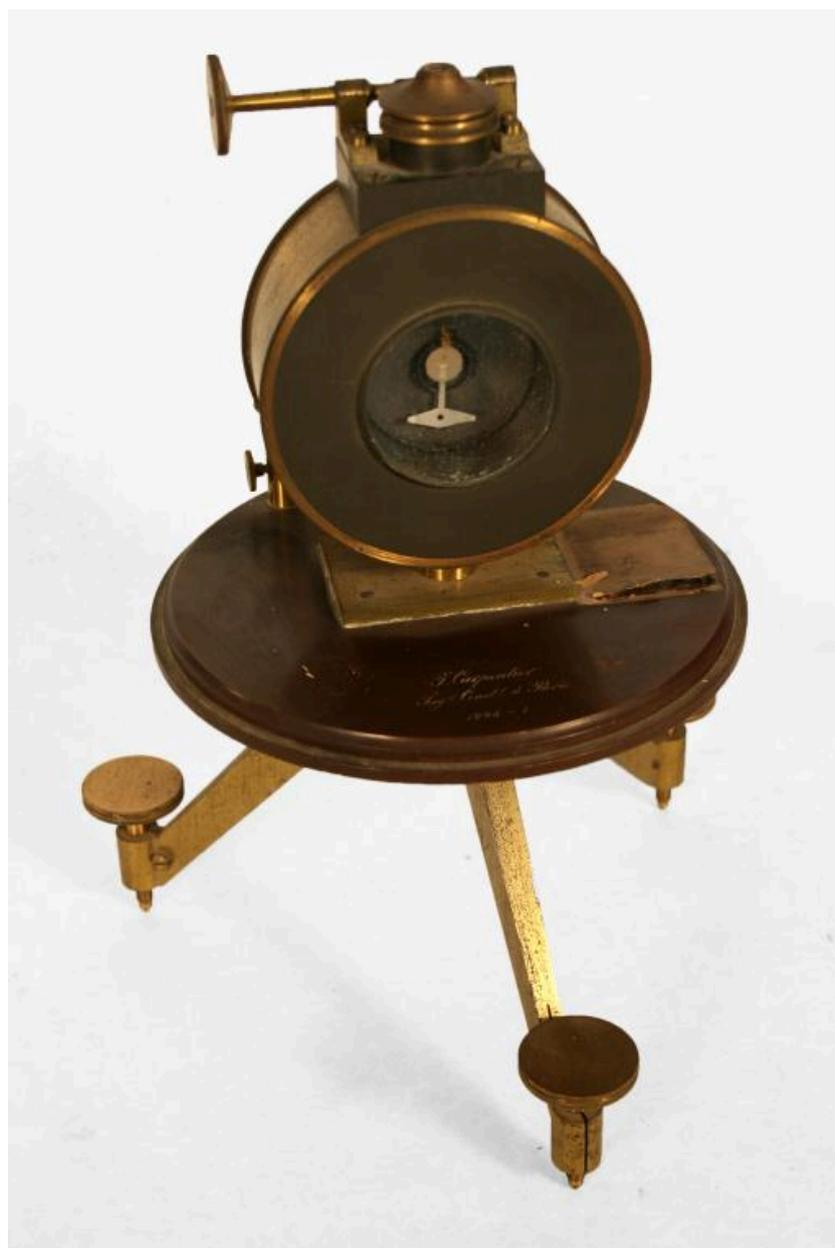
Galvanomètre de Thomson différentiel (modèle à un multiplicateur) - Electricité dynamique
