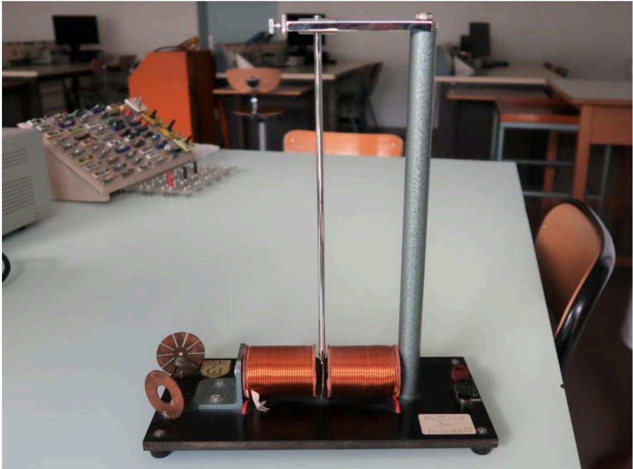
Pendule de Foucault pour courants induits - Electricité dynamique (Eurosap Deyrolle)
