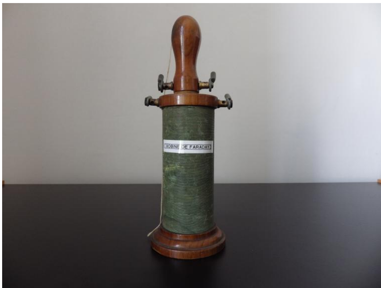
Bobine double de Faraday - Electricité dynamique (Radiguet & Massiot)
