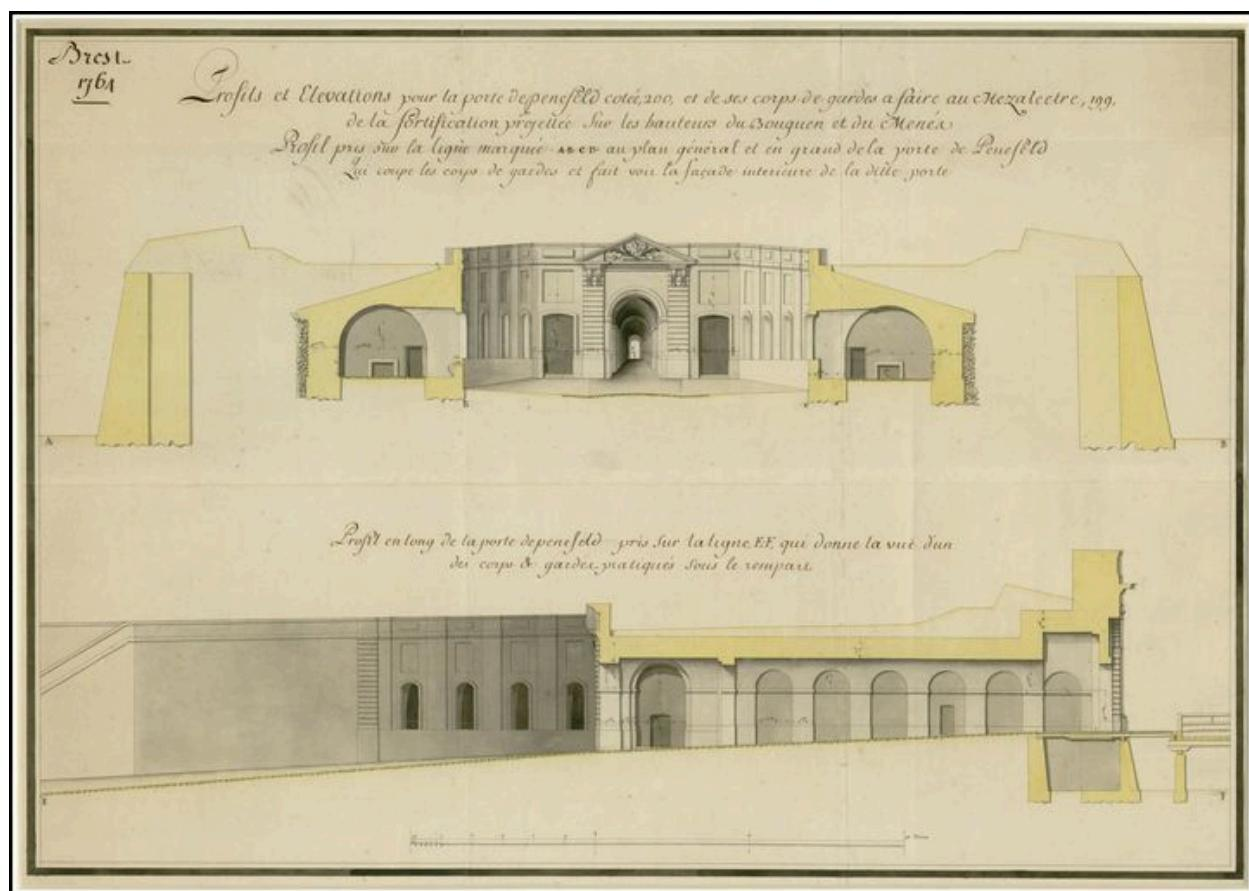
Brest, 1764 : profils et élévations pour la porte de Penfeld (cotée 200) et de ses corps de garde à faire au mézalectre (199) de la fortification projetée sur les hauteurs du Bougen et du Menès, par Pierre Filley de la Côte
