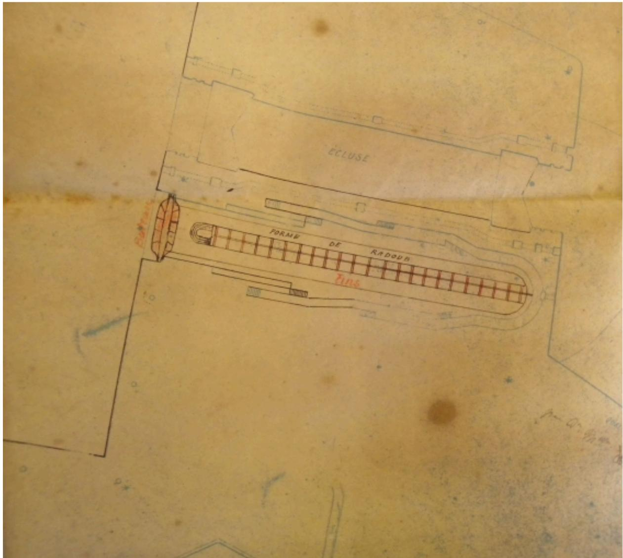
Plan : vue de la forme de radoub et de l'emplacement prévu du du bateau-porte en projet, 1886 (AD 22)
