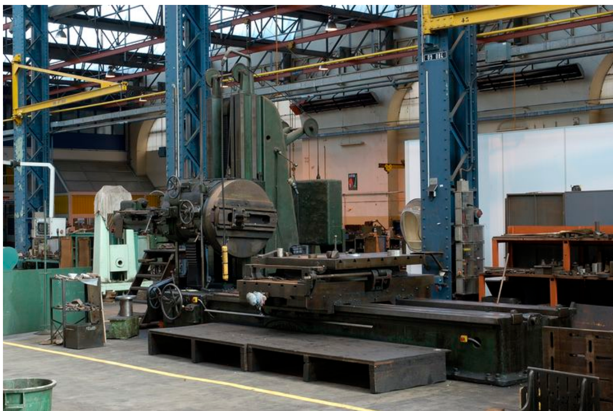
Vue de la halle d'usinage : aléseuse Malf Richard (1948)
