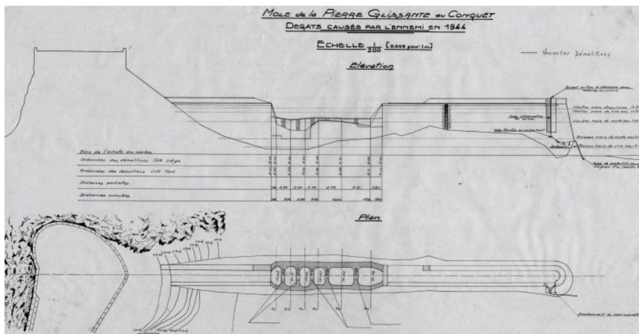
Môle de la pierre-glissante, dégâts causés par l'ennemi en 1944, plan et élévation
