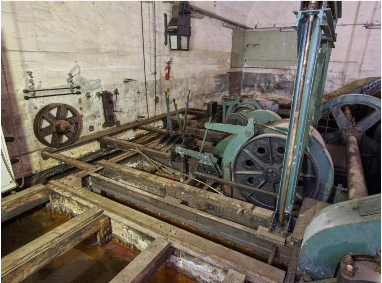
Vue des commandes du treuil et des deux moteurs électriques avec leur frein à tambour
