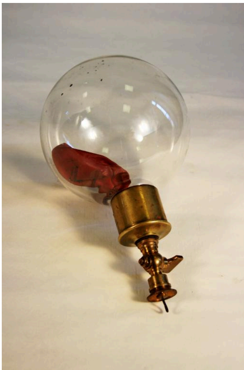
Ballon pour déterminer la masse et la masse volumique d'un gaz - Propriétés des gaz (Non signé)
