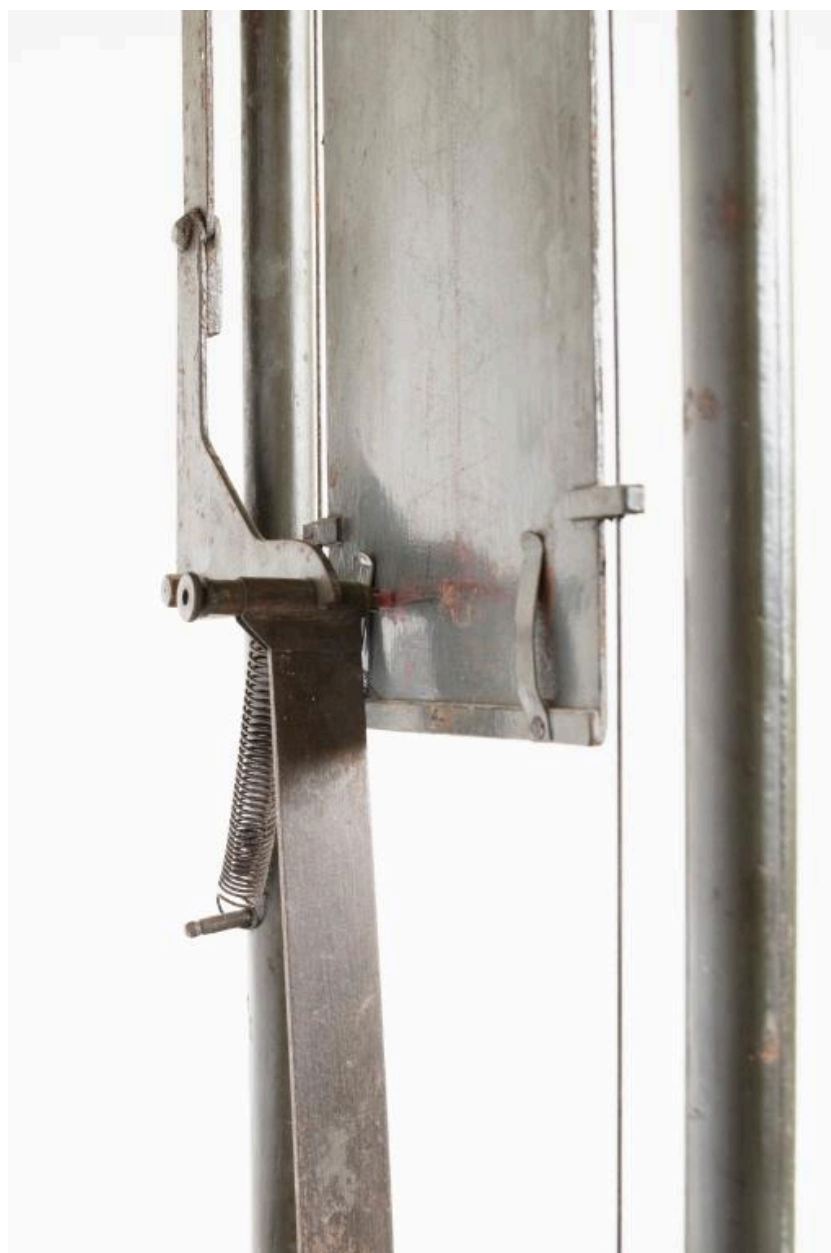
Détail de l'appareil chute libre d'une plaque - Pesanteur-Mécanique-Mesures (Non signé)
