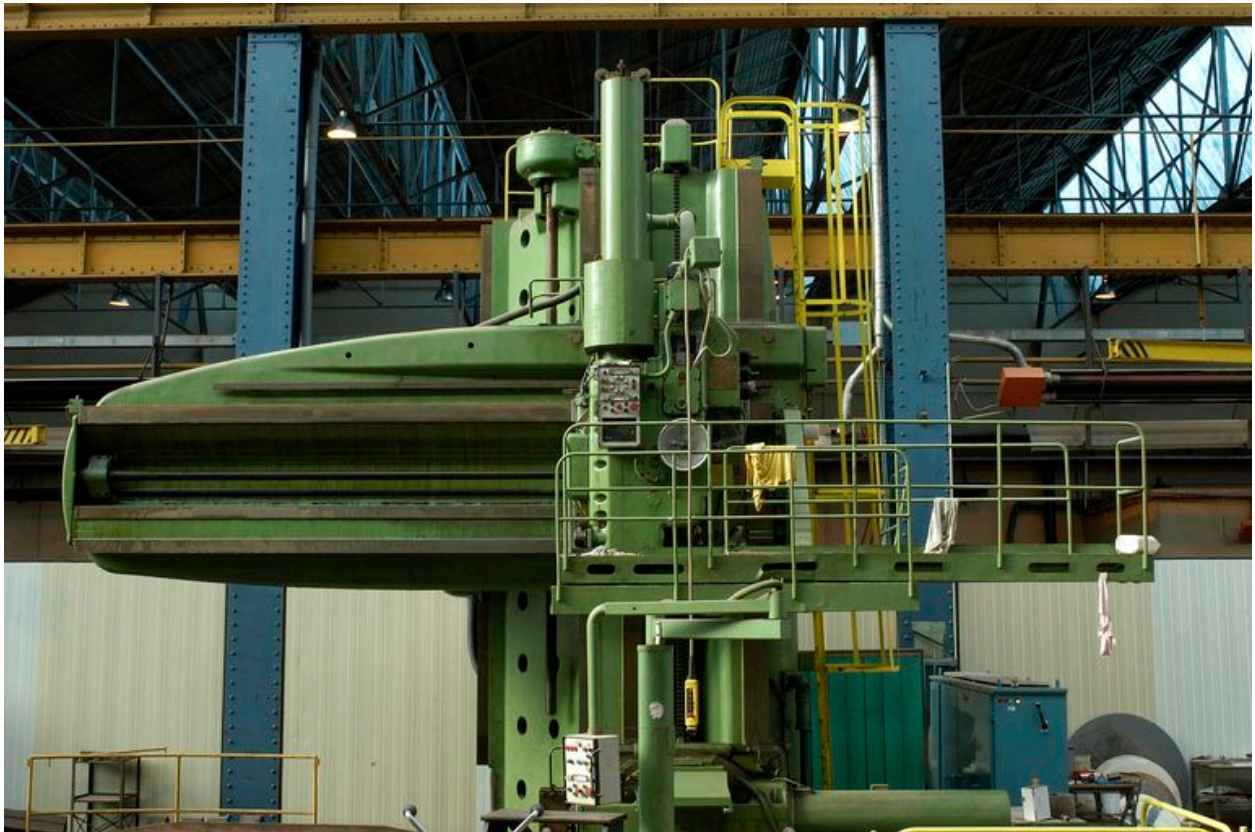
Vue de la halle d'usinage : détail de la partie haute du tour vertical Berthiez (1953)
