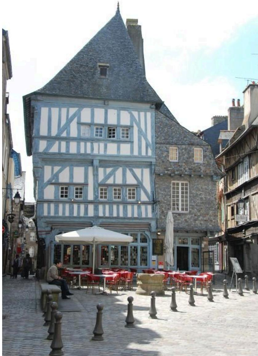
Maison d'angle dont les étages en encorbellement sont contreventés par des écharpes et potelets.
