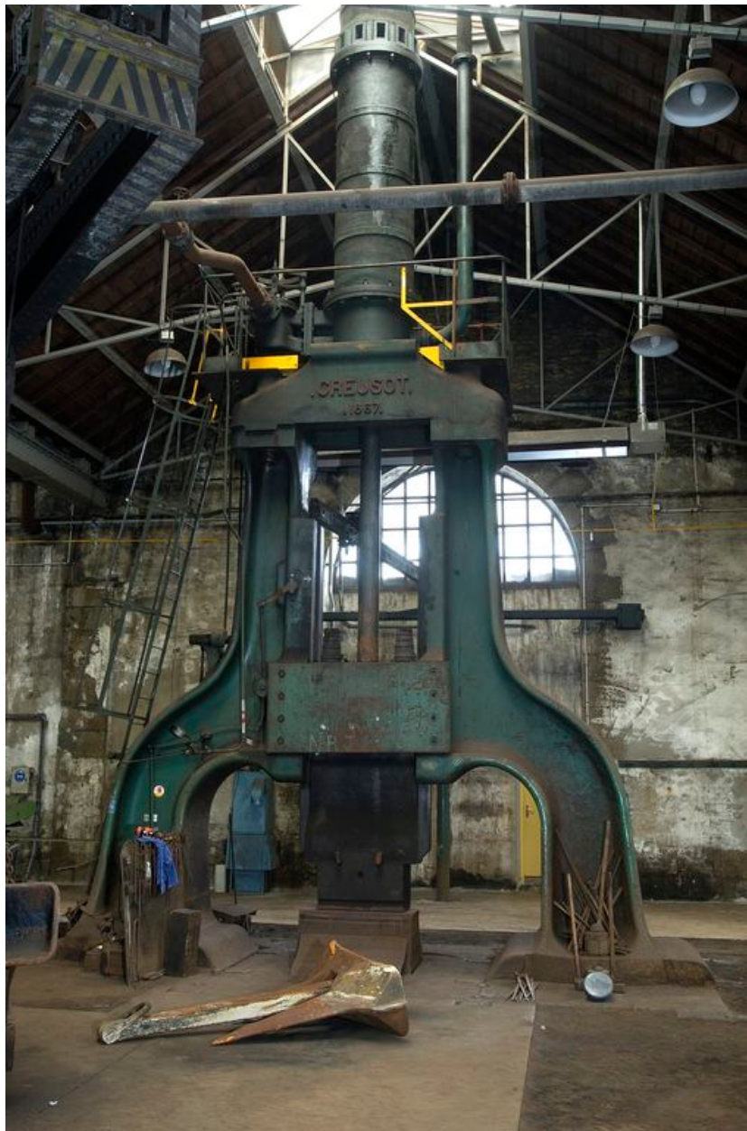
Vue du marteau pilon à un coup du Creusot daté de 1867 des halles du plateau des Capucins
