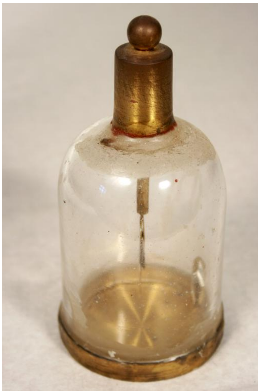
Electroscope à feuilles d'or – Electricité statique (Non signé)
