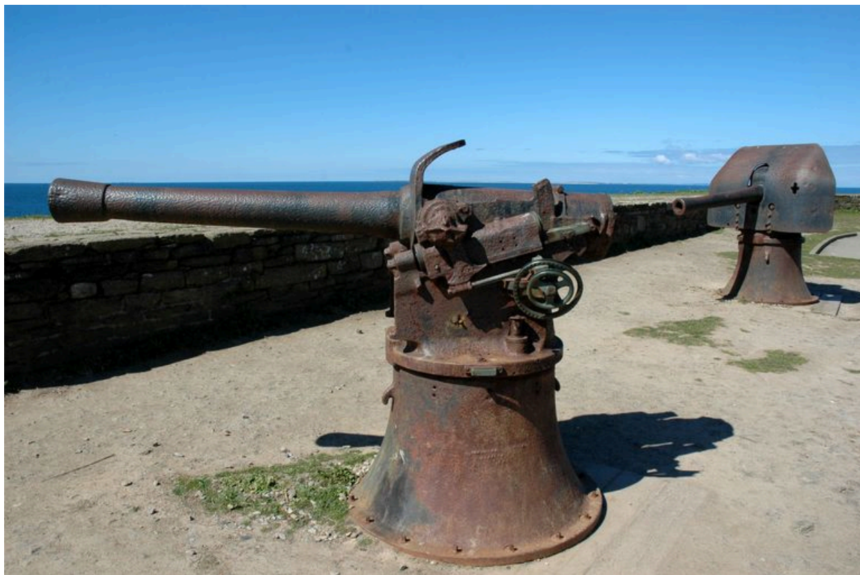
Vue des deux canons de 95 mm Lahitolle modèle 1888 sur leur affût avec masque
