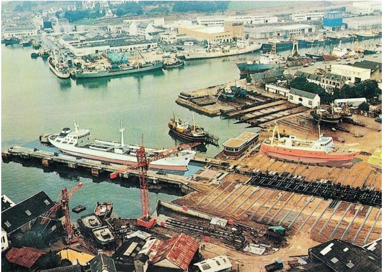
Le site de l'aire de réparation navale : slipway et ascenseur-élévateur
