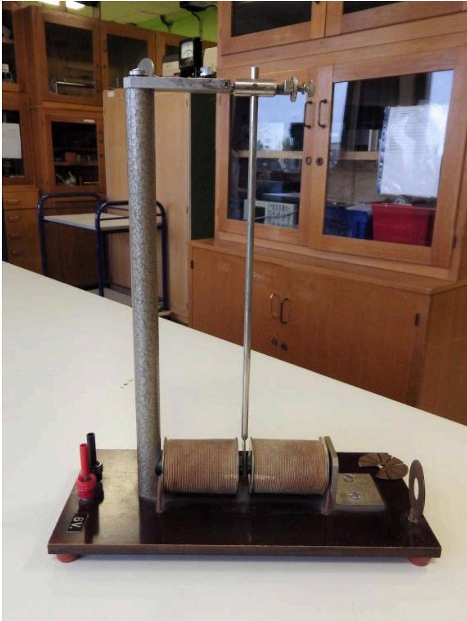
Pendule de Foucault pour courants induits - Electricité dynamique (Eurosap Deyrolle)
