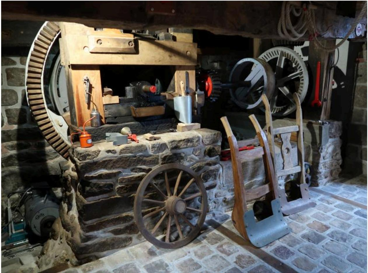
Loguivy-Plougras, le bourg : Moulin à eau de Traou an Dour, détail des mécanismes de transmission (arbre de la roue et rouet à alluchons)
