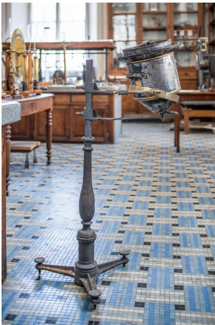
Calorimètre à glace de Laplace et Lavoisier (18e siècle) - Collection d'instruments scientifiques (Chaleur)
