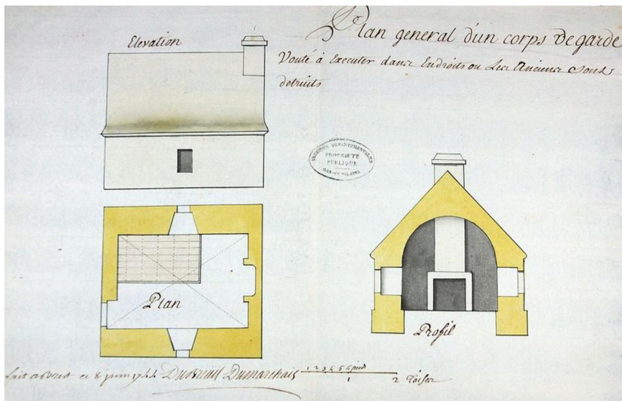
Elévation, plan et profil d'un corps de garde voûté à exécuter dans les endroits ou les anciens sont détruits, fait à Brest le 8 juin 1744 par Dubreuil Dumarchais
