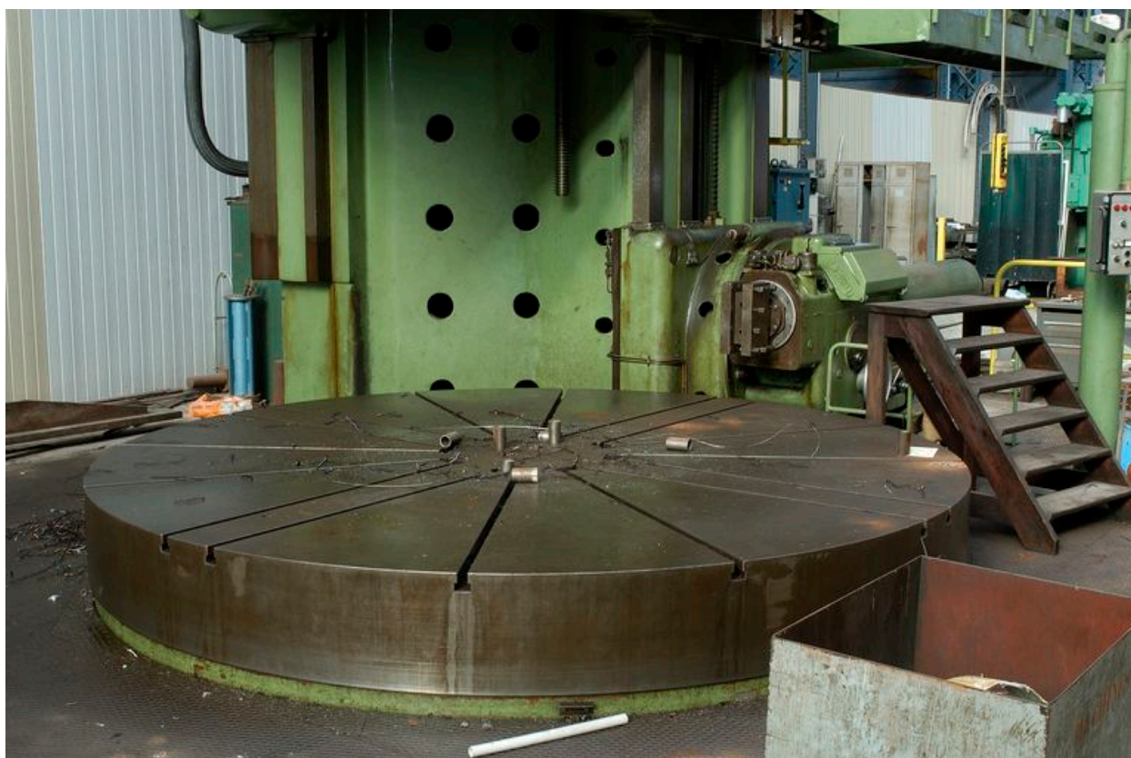
Vue de la halle d'usinage : tour vertical Berthiez (1953), détail du marbre
