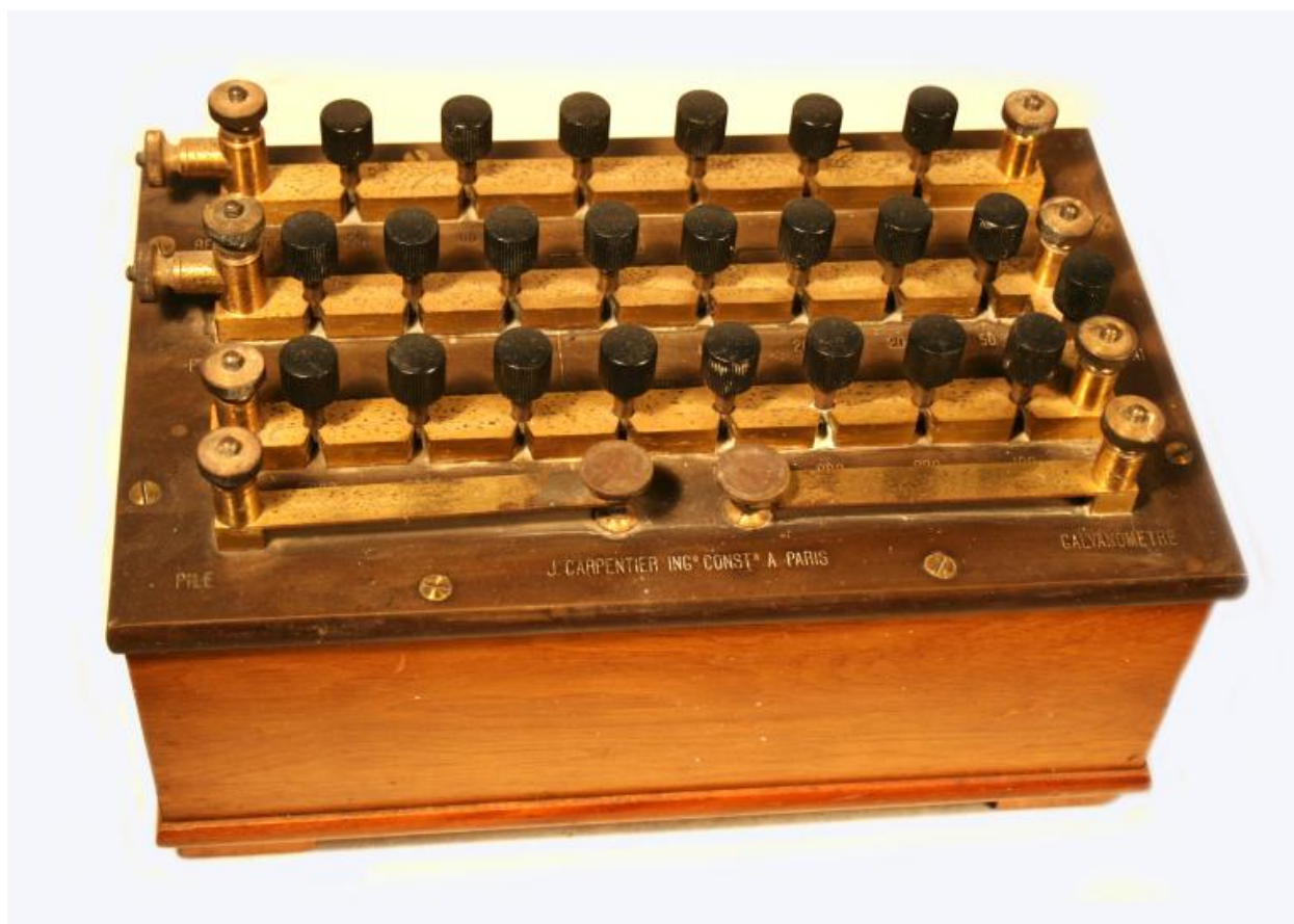
Boîte à pont de Wheatstone - Electricité dynamique (J. Carpentier)
