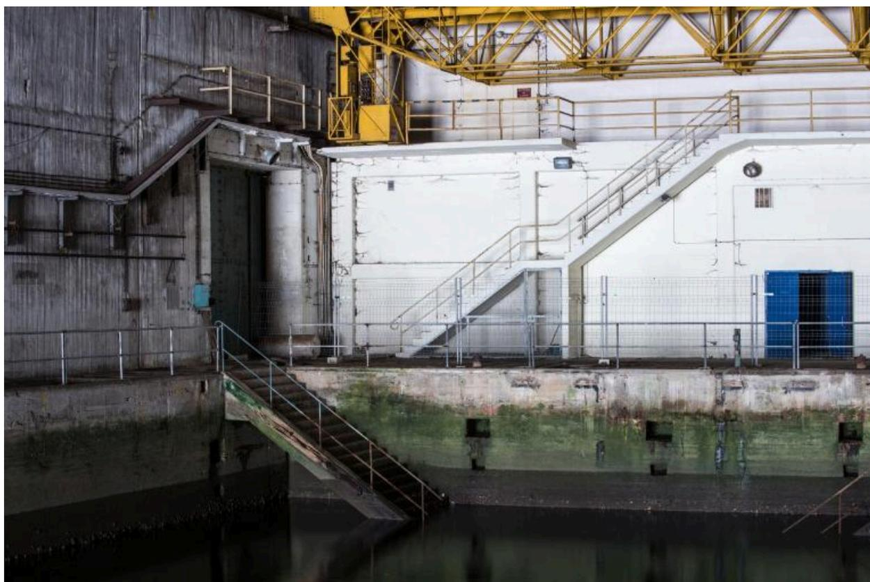
Vue du fond de l'alvéole nord : deux escaliers disposés en vis à vis permettent d'accéder au bassin. Peint en blanc, un troisième escalier donne accès au premier étage. En jaune, le pont roulant Levman arrêté au-dessus de l'avancée du premier étage
