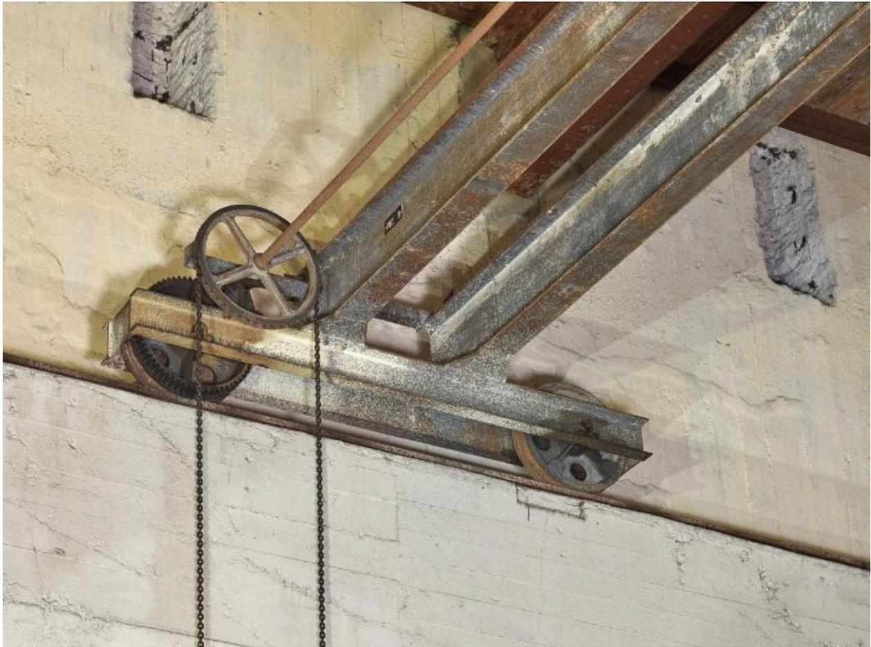
Vue de détail de l'un des deux ponts roulants bipoutres. La chaîne continue permet le déplacement longitudinal du pont roulant (le système est identique à l'opposé mais il a perdu sa chaîne)
