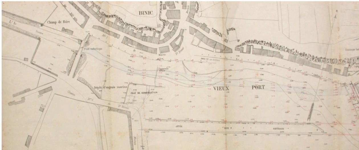
Plan coté du vieux port de Binic, daté du 15 novembre 1906 : remarquer les quais, l'ancien pont métallique, le dépôt d'engrais marins, la vieille cale de construction, la cale de la cloche (AD 22)
