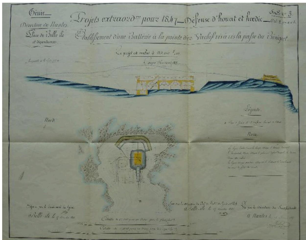
1 VH 292. Place de Belle-Ile, feuille n° 3 des projets extraordinaires pour 1847, établissement d'une batterie à la pointe d'Er Vachif vis-à-vis la passe du Béniguet, 17 décembre 1846.
