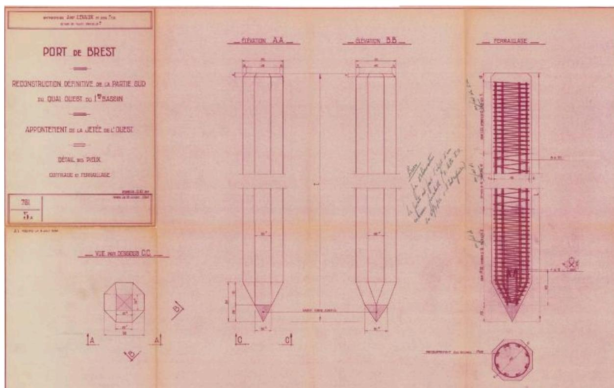
Plan : reconstruction définitive de la partie sud du quai ouest du 1er bassin, appontement de la jetée ouest, détail des pieux, coffrage et ferrailage
