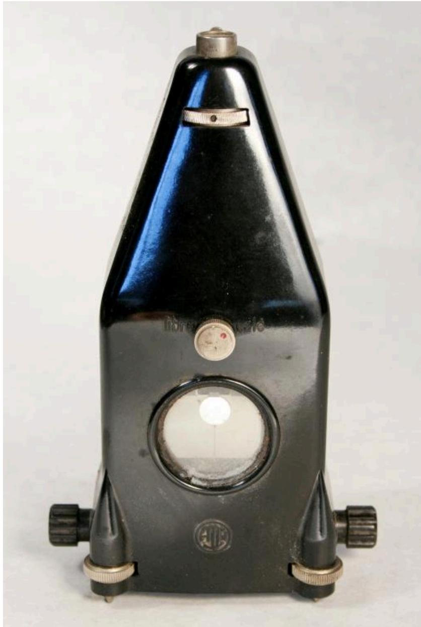
Galvanomètre à cadre mobile Deprez d'Arsonval - Electricité dynamique (A.O.I.P.)
