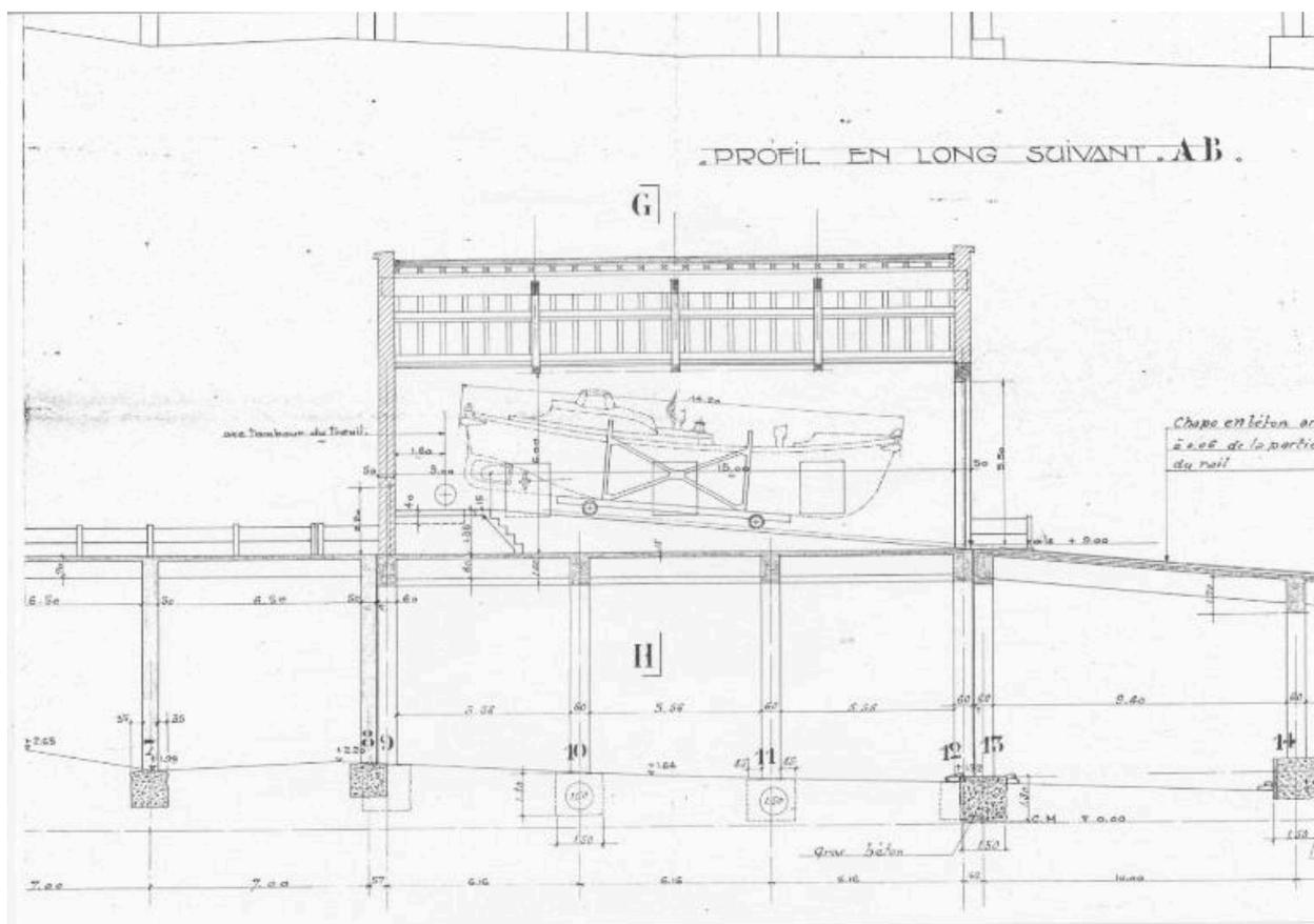
Cale SNSM de Sainte-Evette, profil en long de la cale et de l'abri de canot de sauvetage
