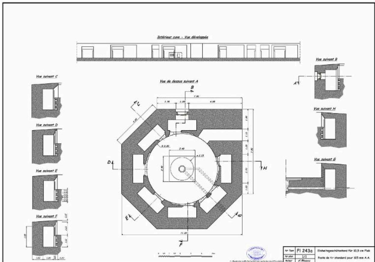
Plan et coupes d'un bunker-cuve de type FI 243a pour canon antiaérien de 10,5 cm (Geschützstand für 10,5 cm Flak). Il s'agit d'un plan standard
